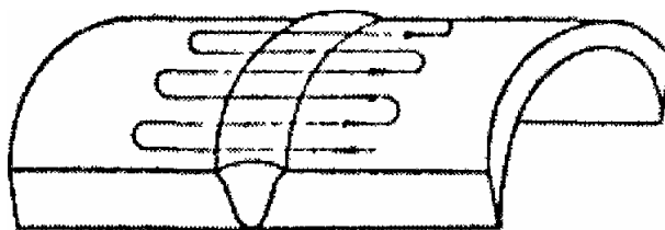
Рисунок Е.1 - Схема перемещения горелки
